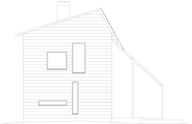
Esimerkki toispuoleisesta harjakatosta kun etelänpuoleiselle lappeelle sijoitetaan aurinkokeräimiä ja/tai aurinkopaneeleita
